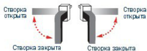
Рис. 1 Схема поворота ручки для открывания поворотной створки
