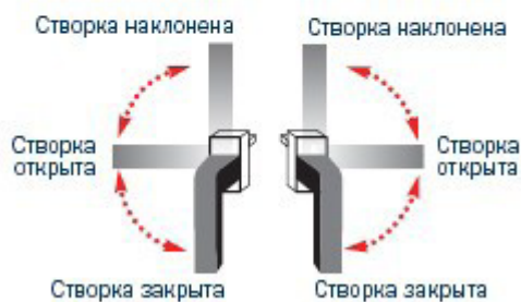
Рис. 2 Схема поворота ручки для открывания поворотно-откидной створки
