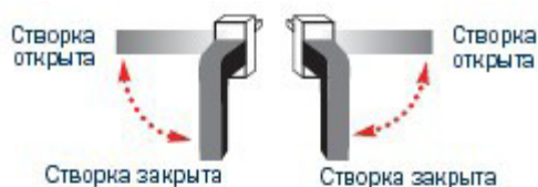
Рис. 1 Схема поворота ручки для открывания поворотной створки
