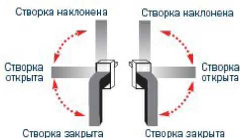
Рис. 2 Схема поворота ручки для открывания поворотно-откидной створки
